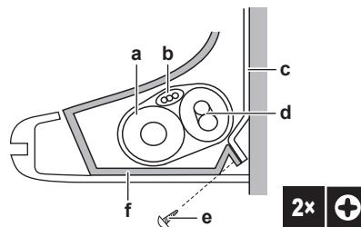
a) Crijev za odvod kondenzata
